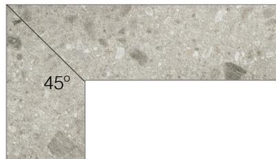
I top a forma di L, realizzati in un solo pezzo senza angolo a 45° devono avere un raggio minimo di 2 mm. Prima di installare un top di questo tipo, accertarsi che i mobili siano livellati e in perfette condizioni.
