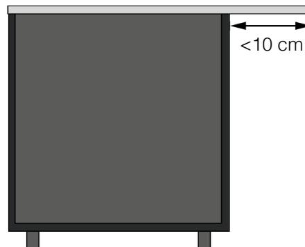
Per la realizzazione di un elemento a sbalzo con la lastra, occorre uno studio preliminare per confermare la possibilità di farlo e determinare i rinforzi idonei caso per caso.
